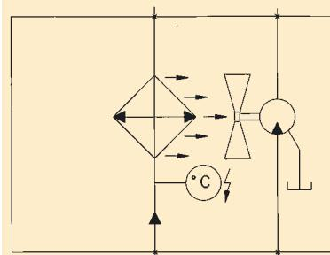
Schéma připojení pro vzduchový chladič oleje LHC.
